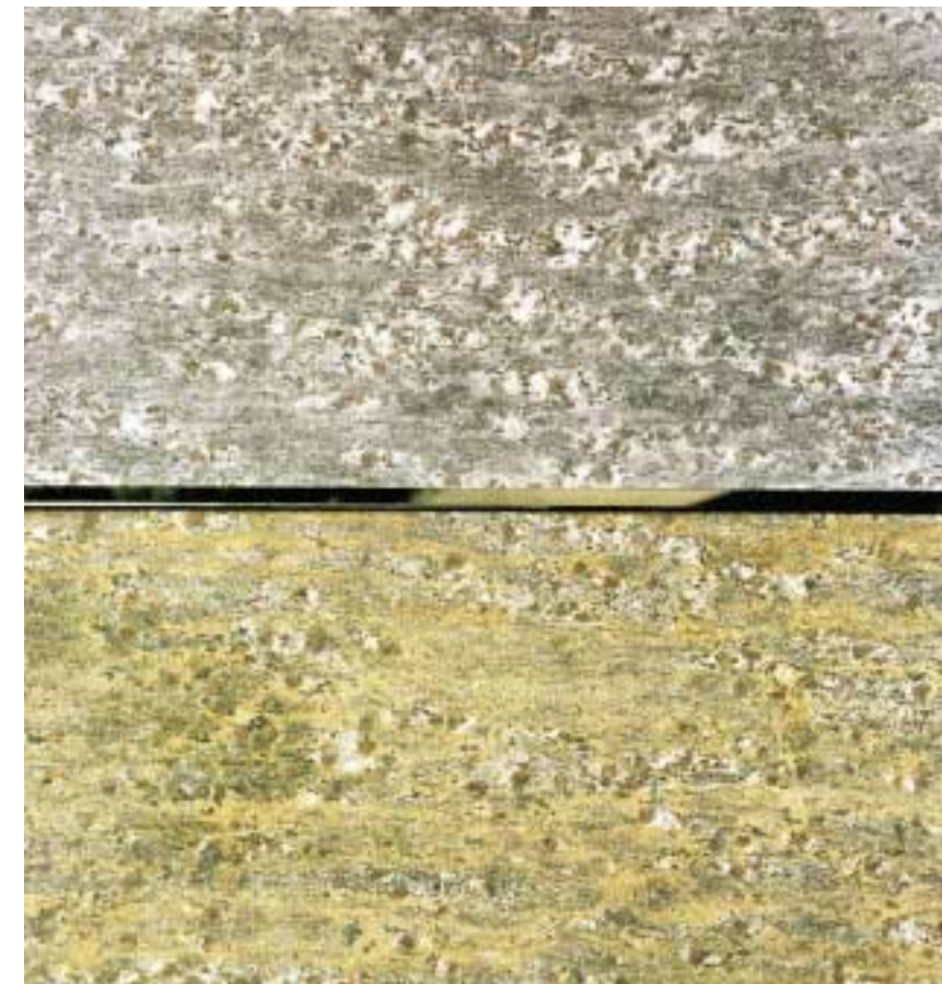
Bild 3: Verwitterungsbedingte Verfärbung eines Kalksilikarfelses (Castione), oben Ersatzplatte bruchfrisch, unten Platte nach 25 Jahren (Stadt Zürich).
